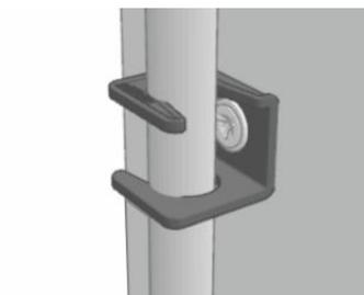
OBS: Para instalação com finca-pino, utilize um pino com arruela plana, não utilize pino com arruela cônica. A pressão utilizada na ferramenta de pino deve ser em nível 3 de pressão, porém esse nível pode alterar de ferramenta para ferramenta, antes de iniciar a aplicação, realize testes para verificar a pressão ideal de fixação.
